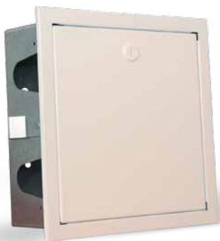
Typ RT kunststoffbeschichtet Abdeckung pulverbeschichtet, ähnlich weiß RAL9016, ca. 15 mm breiter umlaufender Rahmen sowie Stecktür mit Schlitzschloss auch als verzinkte Ausführung erhältlich (für alle Einbauschrankgrößen)
