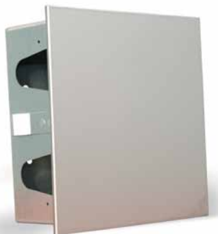
Typ AMM Edelstahlabdeckung matt geschliffen, mit Magnethalterung und Verrutschsicherung (für alle Einbauschrankgrößen bis 380 x 380 mm)
